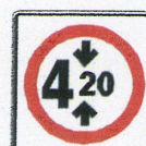
SR-15 Altura libre restringida
