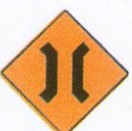
SP-23 Puente angosto
